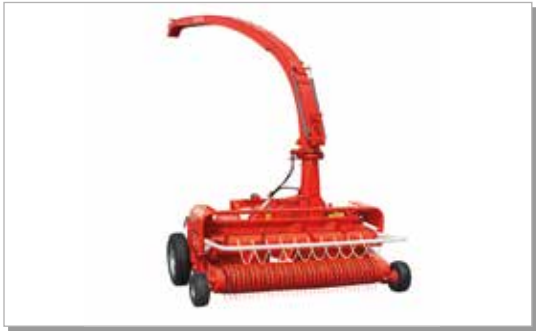
C2200 un C3000 modeļa smalcinātāji var būt aprīkoti ar 2 vai 3 m platuma zāles savācēju, tādējādi tiek vēl vairāk paplašinātas iekārtas lietošanas iespējas.
