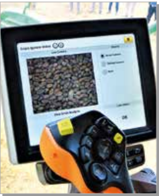
Izmantojot videokameras un sensorus, kombains, ņemot vērā slodzi un noteikto ražas kvalitāti, pats automātiski noregulē kombaina komponentus
