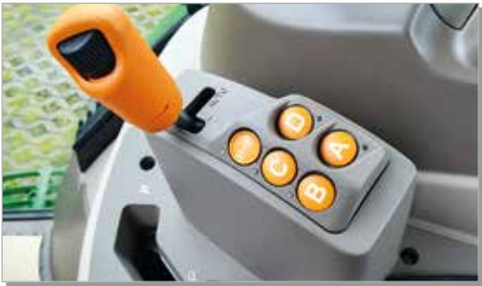
Jaunā CommandQuad plus transmisija. Šai transmisijai ir pilnībā automātisks pārnēsumu pārslēgšanas režīms un automātiskās sakābes funkcija.
