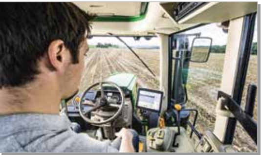
AutoTrac automatiskās stūrēšanas sistēma palīdz izvairīties no krustošanās un mazina operatora nogurumu, ļaujot strādāt ražīgāk, ātrāk un ērtāk.
