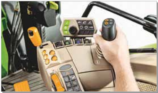
CommandArm daudzfunkcionālais rokas balsts: visu traktora, frontālā iekrāvēja un darba rīka funkciju vadība vienā vietā.
