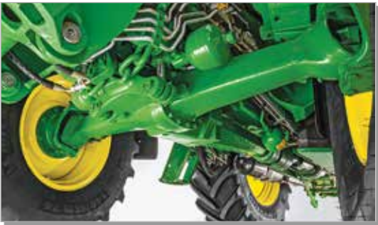
Amortizējošs priekšējais tilts un kabīnes amortizācija nodrošina nevainojamu darbu gan uz lauka, gan uz ceļa.
