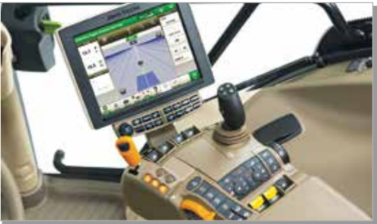
CommandArm rokas balsts ar integrētu CommandCenter4 vadības monitoru ļauj visas traktora un darba rīka funkcijas ērti pārvaldīt vienā vietā.
