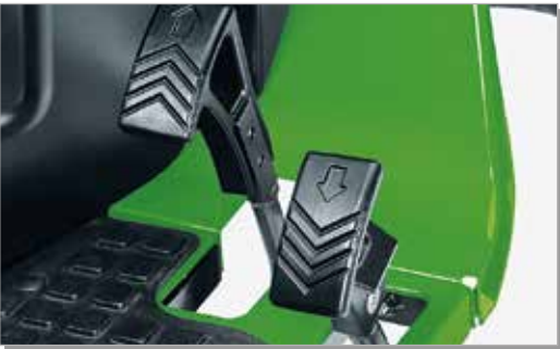
Hidrostatiskās transmisijas pedāļi – ātrai virziena maiņai un precīzai ātruma izvēlei.
