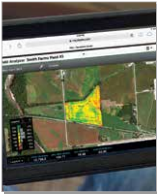
Automātiski ievāc datus par ražu, tās daudzumu un mitrumu, lai vēlāk tos varētu analizēt
