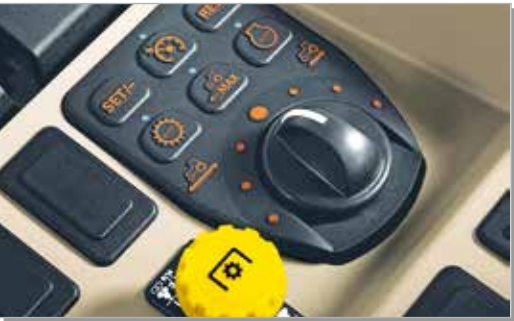
Hidrostatiskās transmisijas vadības ierīces – ar tām var optimizēt transmisijas un traktora darbu.
