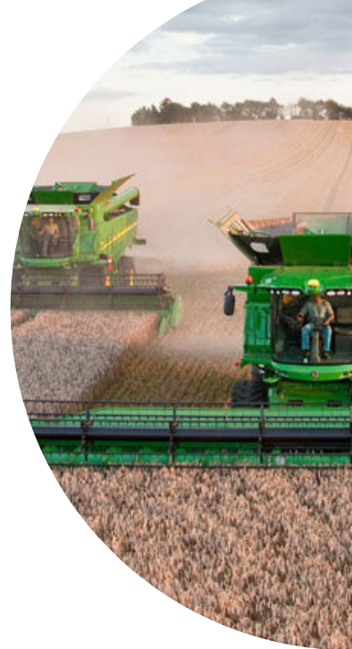
Tradicionālais, viena trumuļa (kulšanai) ar kratītājiem (separēšanai)
