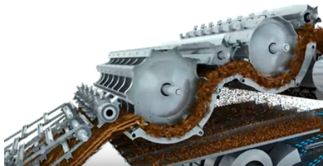
Vairāku trumuļu, trumuļi (kulšanai) ar kratītājiem (separēšanai)
