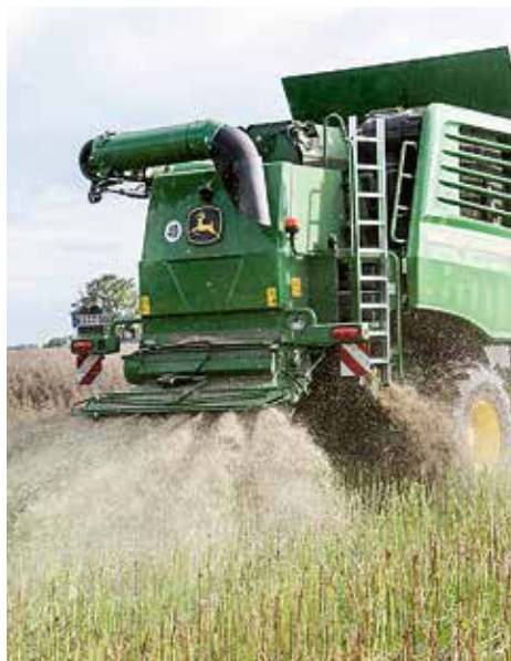
Par salmu smalcinātāja vai pelavu izkļiedētāja efektivitāti sūdzību nav. Taču smalcinātāja piedziņas sajūgu gan nepieciešams ieslēgt manuāli.
