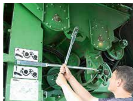
Rotējošo atdalītāja kuļkurvi ir vienkārši iestatīt vajadzīgajā pozīcijā.
