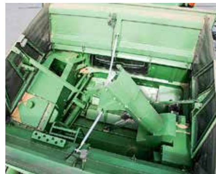
10 m 3 graudu bunkurā ietilpst vairāk nekā 7,5 t kviešu, un tas iztukšojas tikai 84 sekundēs. Žēl, ka ir tik daudz vietu, kur graudiem aizķerties.
