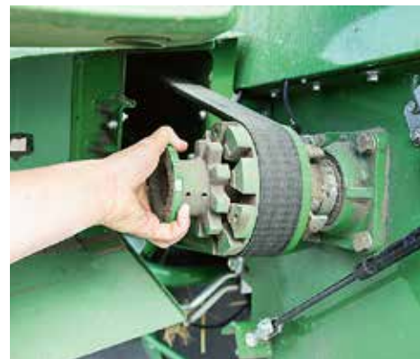
Par salmu smalcinātāja vai pelavu izkļiedētāja efektivitāti sūdzību nav. Taču smalcinātāja piedziņas sajūgu gan nepieciešams ieslēgt manuāli.
