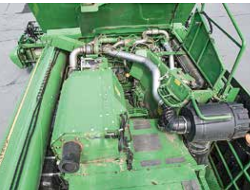
Ar 382 ZS maksimālo jaudu šis 9 litru sešcilindru PSS dzinējs vienmēr darbu paveica pirmšķirīgi.
